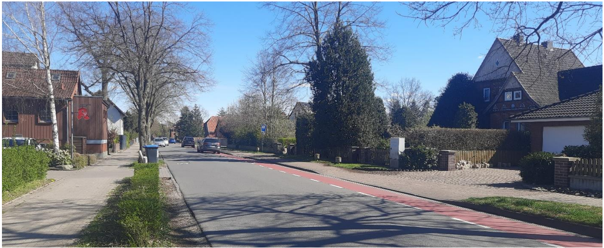
Abbildung 59 Schutzstreifen in Wettmar, Hauptstraße
